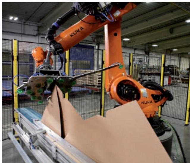
přířezy z vlnité lepenky, které se používají jako výplně a fixáže v obalech určených pro automobilový průmysl. Archy vlnité lepenky jsou přiváděny ze zásobníku do pracovního prostoru malého lehkého robota. Ten vezme přířez chapadlem a složí jej podél předem stanovené linky ohybu a poté umístí přířez do držáku a složí z něj krabici. Následně robot podá složený polotovar do sešívacího zařízení
